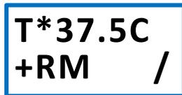
**高温报警显示 (图 2)** – 如果孵化器内部的测量温度超过设定的高温报警温度值，报警会立即响起，并显示“H”。按下“OK”按钮可将报警静音 30 分钟。
